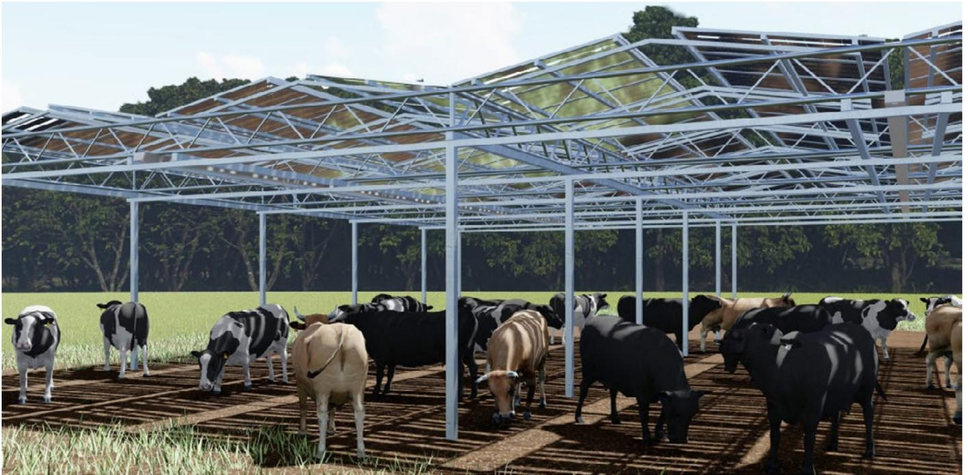
1,1 ha **Unterstand für Rinder** mit Stall und Wasserführung: 10 m Reihenabstand, 1.100 kWp/ha, Investition ohne Netzanschluss ca. € 1.265.000, Stromertrag p.a. bis zu 1.160 MWh = € 232.000 € bei 0,20 € kWh. Regenwassergewinnung in Brandenburg (590 mm Niederschlag) 5.300 m<sup>3</sup> Wasserüberschuß p.a., ausreichend für 2,5 ha Bewässerung.
