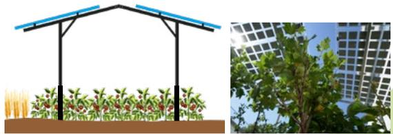
aufgeständerte AgriPV Anlagen zum geschützten Anbau von Obst und Gemüse mit Doppelglas Modulen in verschiedenen Transparenzgraden
