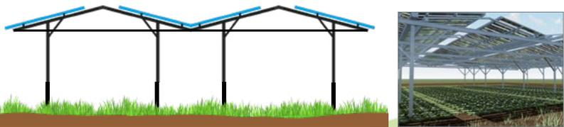
aufgeständerte AgriPV Anlagen für große Feldplantagen mit robusten und transparenten Doppelglas Modulen zum geschützten Pflanzenanbau und gleichzeitiger Energiegewinnung.
