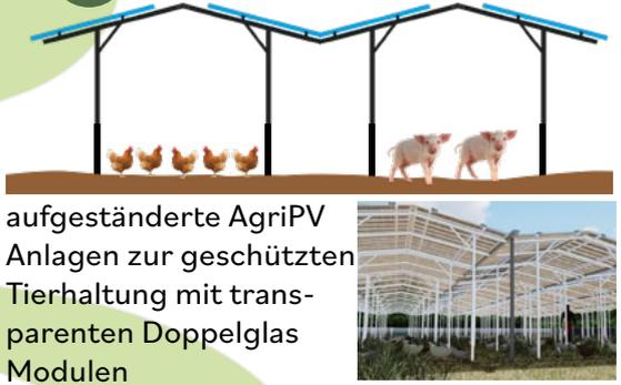
aufgeständerte AgriPV Anlagen zur geschützten Tierhaltung mit transparenten Doppelglas Modulen
