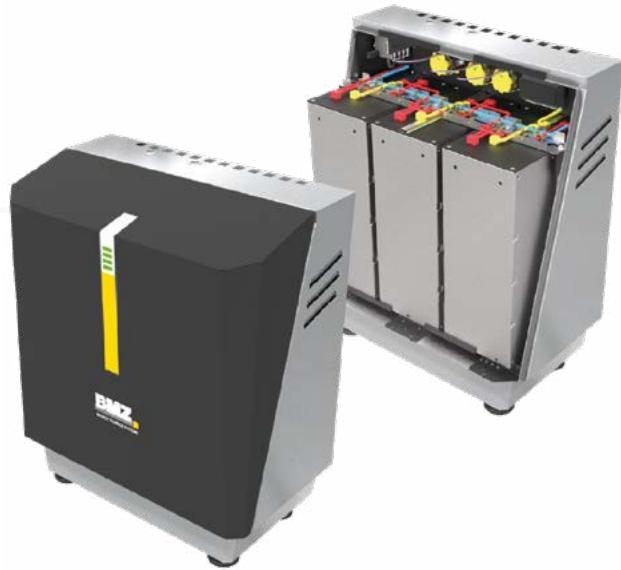
Der neue innovative Hochvolt-Speicher Hyperion ermöglicht durch seine Modularität sowohl eine einfache und gleichzeitig zuverlässige Installation als auch eine zukünftige Erweiterung des Speichers, falls höhere Energiemengen notwendig werden. Das „Made in Germany“-Produkt kann mit mindestens drei und maximal sechs Modulen mit einer Gesamtkapazität von bis zu 18 kWh ausgestattet werden. Die bis zu 6 Batterieblöcke sind sicher in dem Systemgehäuse konfektioniert.
